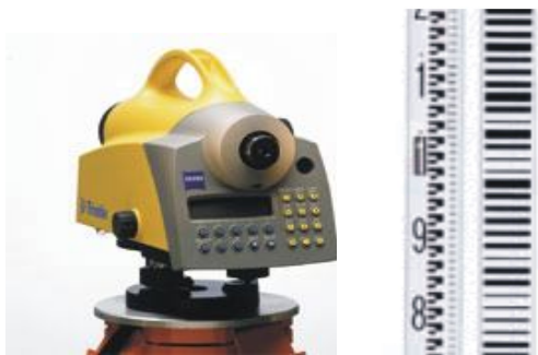
Рис. 30. Цифровой нивелир Trimble DiNi 12 и штрих-кодовая рейка
