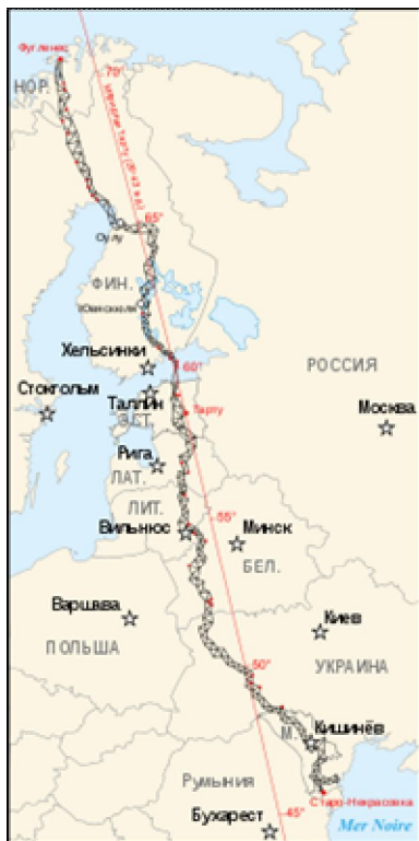
Рис. 5. Дуга Струве: а) ряд триангуляции; б) пункт дуги
